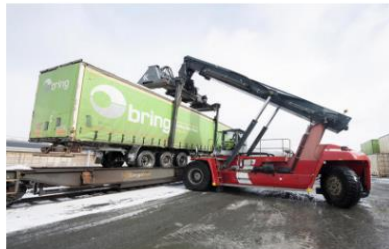
Trailere med armeringsnett løftes rett på toget i Mo i Rana. (Foto: Rami Aboud Skonseng)
